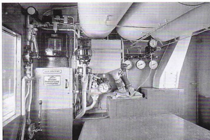
Die Leistungssteuerung erfolgte über ein so genanntes „Gebus“-System rein elektrisch per Drehzahlsteller an den Dieselmotoren.
